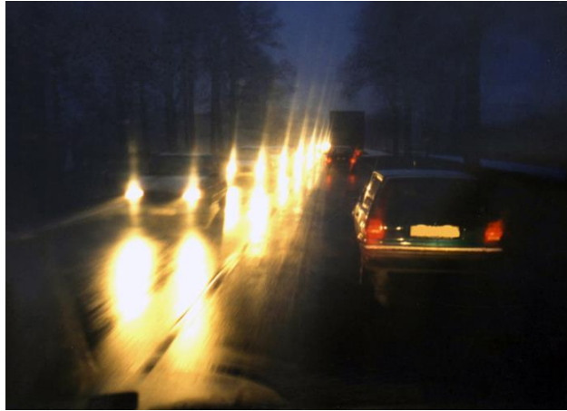
Ilustración 4: Deslumbramiento de los faros sobre el pavimento.
