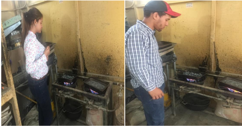
Ilustración 22: Calentamiento de los agregados para el peso seco. Fuente: Laboratorios P & R Ingeniería.
