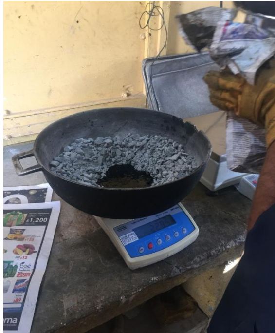
Ilustración 24: Colocación de AC-30 con polímero en los agregados. Fuente: Laboratorios P & R Ingeniería.
