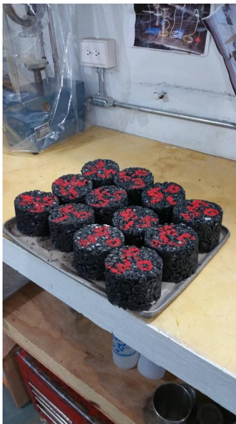
Ilustración 11: Briquetas. Fuente: Laboratorio P & R Ingeniería.
