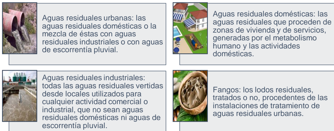
Ilustración 1. Clasificación de las aguas residuales Fuente: (Soldevilla, 2011)
