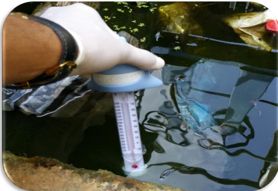
Ilustración 7. Toma de temperatura de la muestra seleccionada Fuente: Propia
