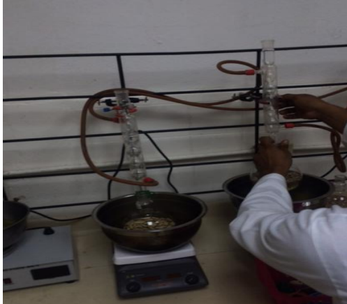
Montaje del equipo de extracción . Foto: Pérez, S., Hsieh, A., 2016
