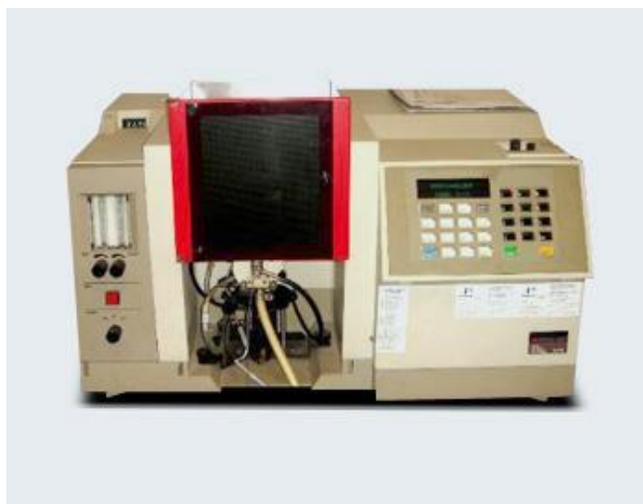
**Equipo para espectroscopía de absorción atómica. Fuente: analítica del nordeste**
