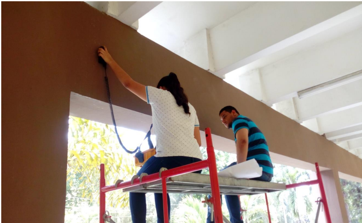
Realización del levantamiento de acero longitudinal y transversal en vigas con el RebarScope.
