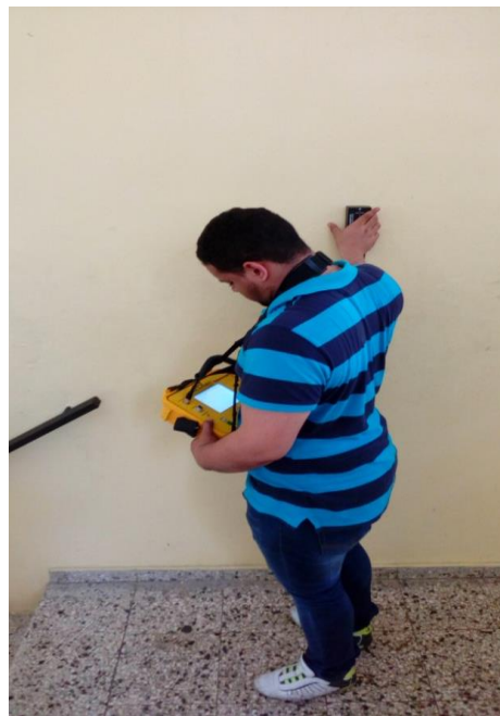
Levantamiento muro escalera con el Rebar Scope
