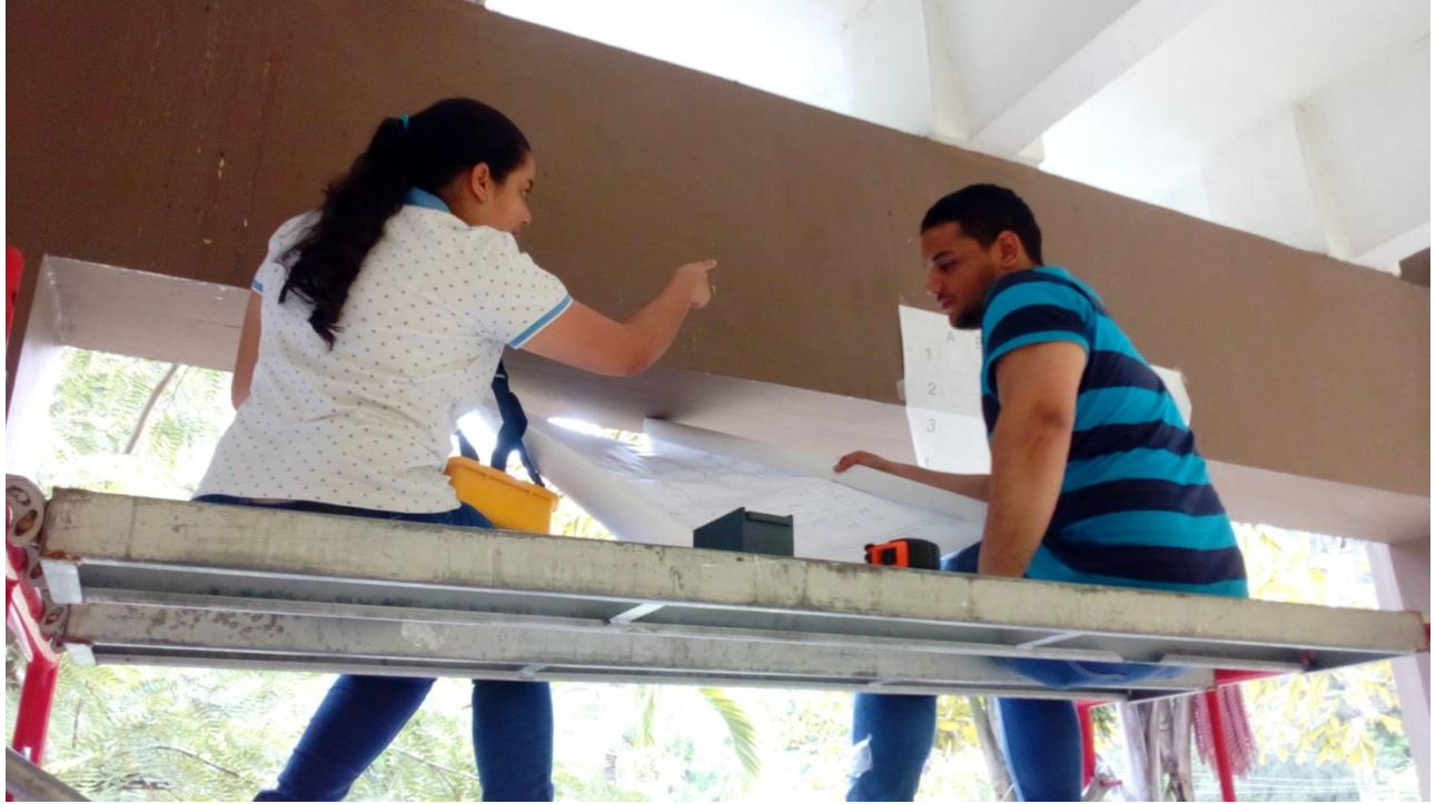
Realización del levantamiento de acero longitudinal y transversal en vigas con el RebarScope.
