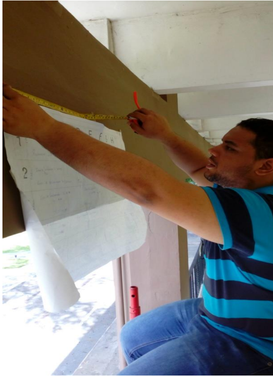
Levantamiento con plantilla de las zonas de confinamiento y no confinamiento de las vigas del edificio 2 de la UNPHU
