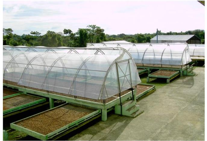
Secadero tipo túnel con plataforma de madera
