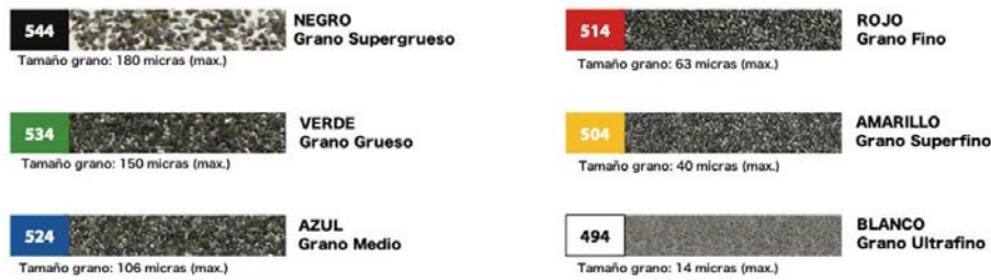
Figura 12. Código de colores para granulación de fresas diamantadas. 26
