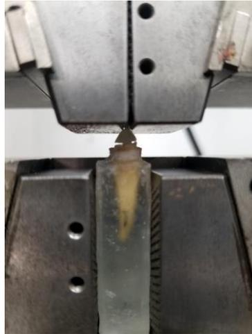
Figura 5. Ensayo de tracción en maquina instrom serie 3369
