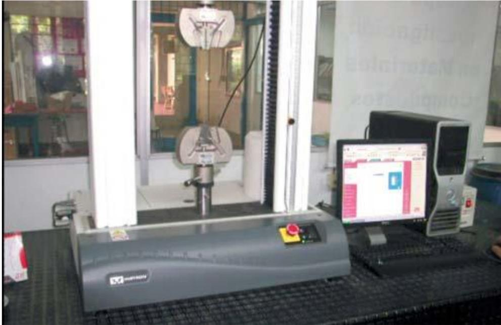
Imagen 5. Máquina universal de ensayos Instron serie 3369 realizando un ensayo de tracción.<sup>49</sup>
