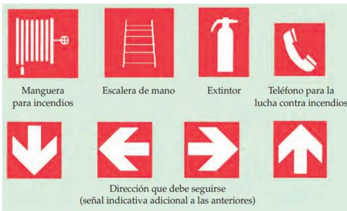
Figura no. 4 Señales equipos de lucha contra incendios.
