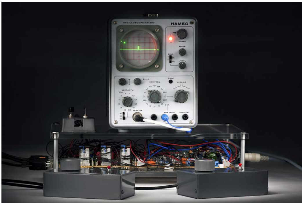
Imagen 11. Clon de Tennis for Two en un osciloscopio moderno. (Fuente: Vocal Media)
