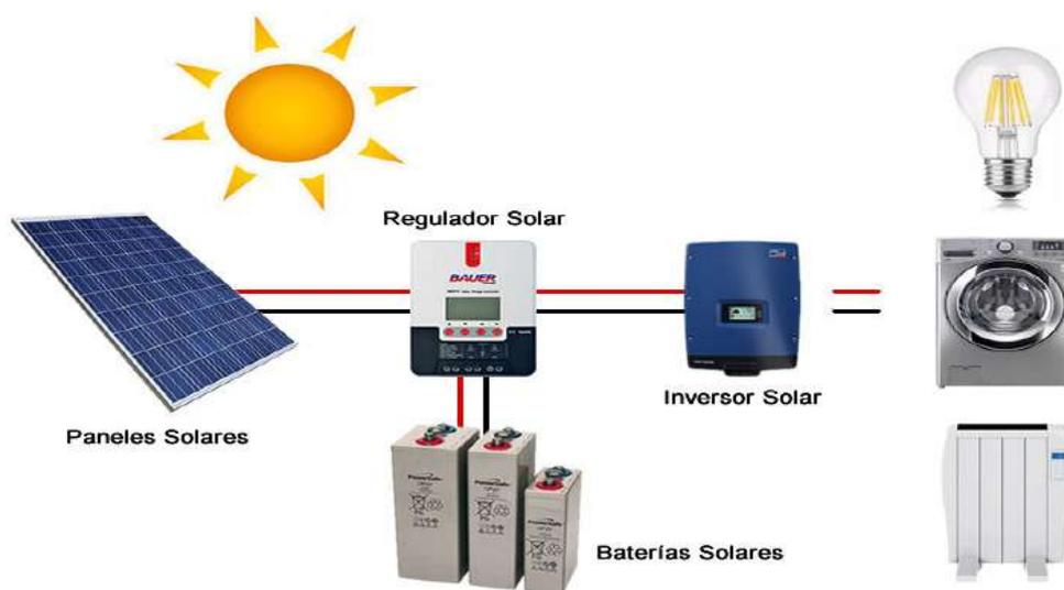
*Figura 5: Sistema aislante energía fotovoltaica.
