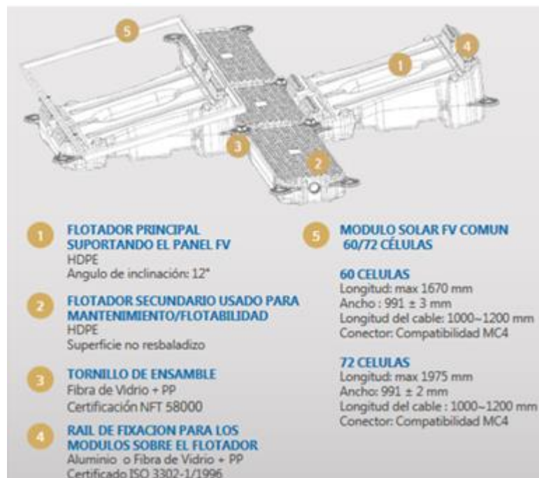
Ilustración 20: Ficha técnica de sistema Hydrelío
