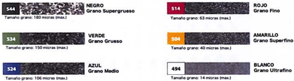
Figura 12. Código de colores para granulación de fresas diamantadas. 26
