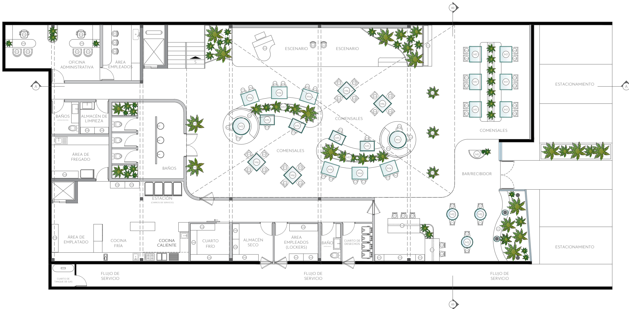
PLANTA DE MOBILIARIO PRIMER NIVEL ESC 1:150
