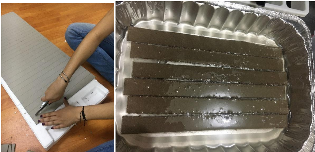
Fig. 12. Preparación del tratamiento ácido oxálico en tablillas de cartón.
