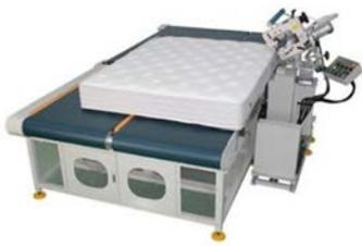
Ilustración 10: Máquina Cerradora de Colchones (Stenburg Machinery, 2019)
