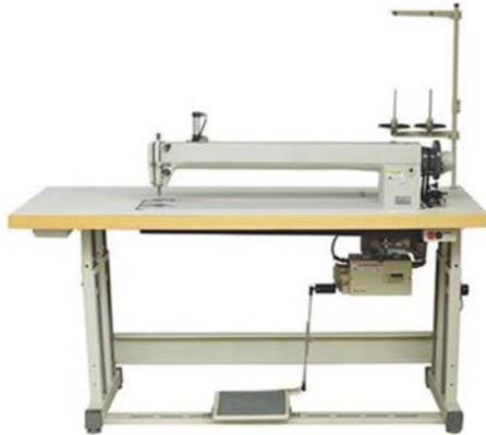
Ilustración 14: Máquina Zigzag de Brazo Largo Trade Mark (Stenburg Machinery, 2019)
