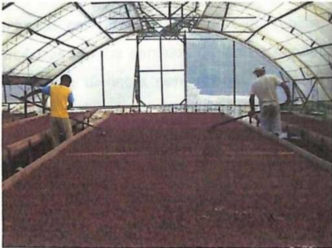
Secadero tipo túnel con plataforma de Cuadrículas
