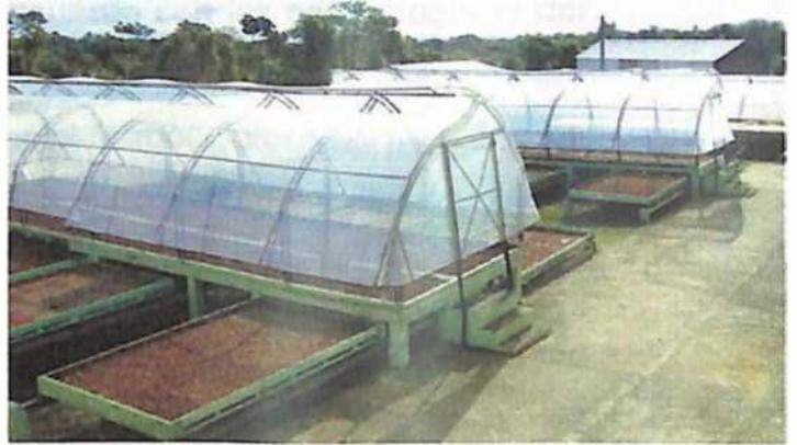
Secadero tipo túnel con plataforma de madera
