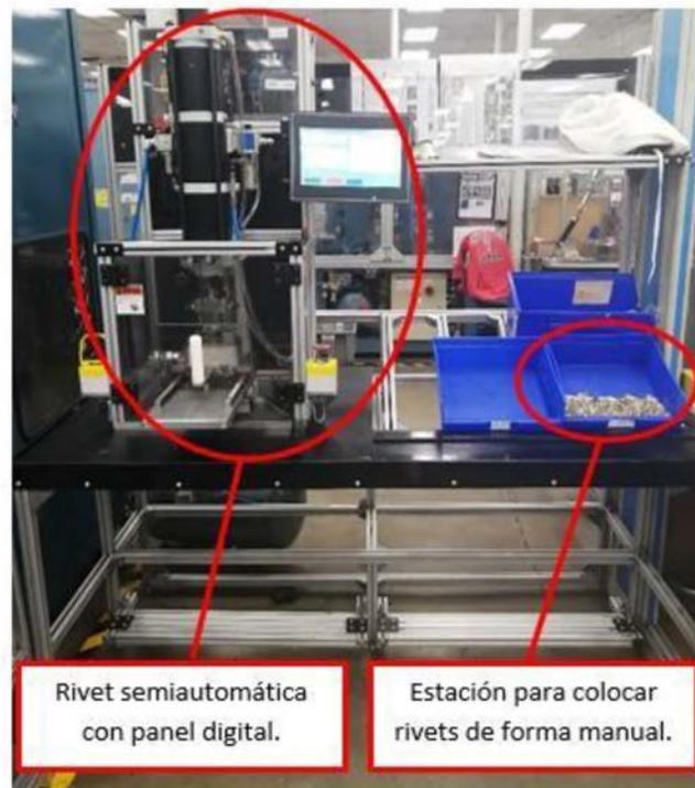
**Lista de componentes para fabricación 1ra Rivet**
