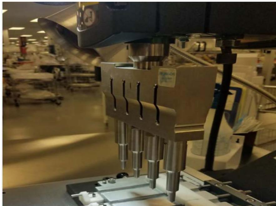
Figura 22. Ultrasonic welding aplicador
