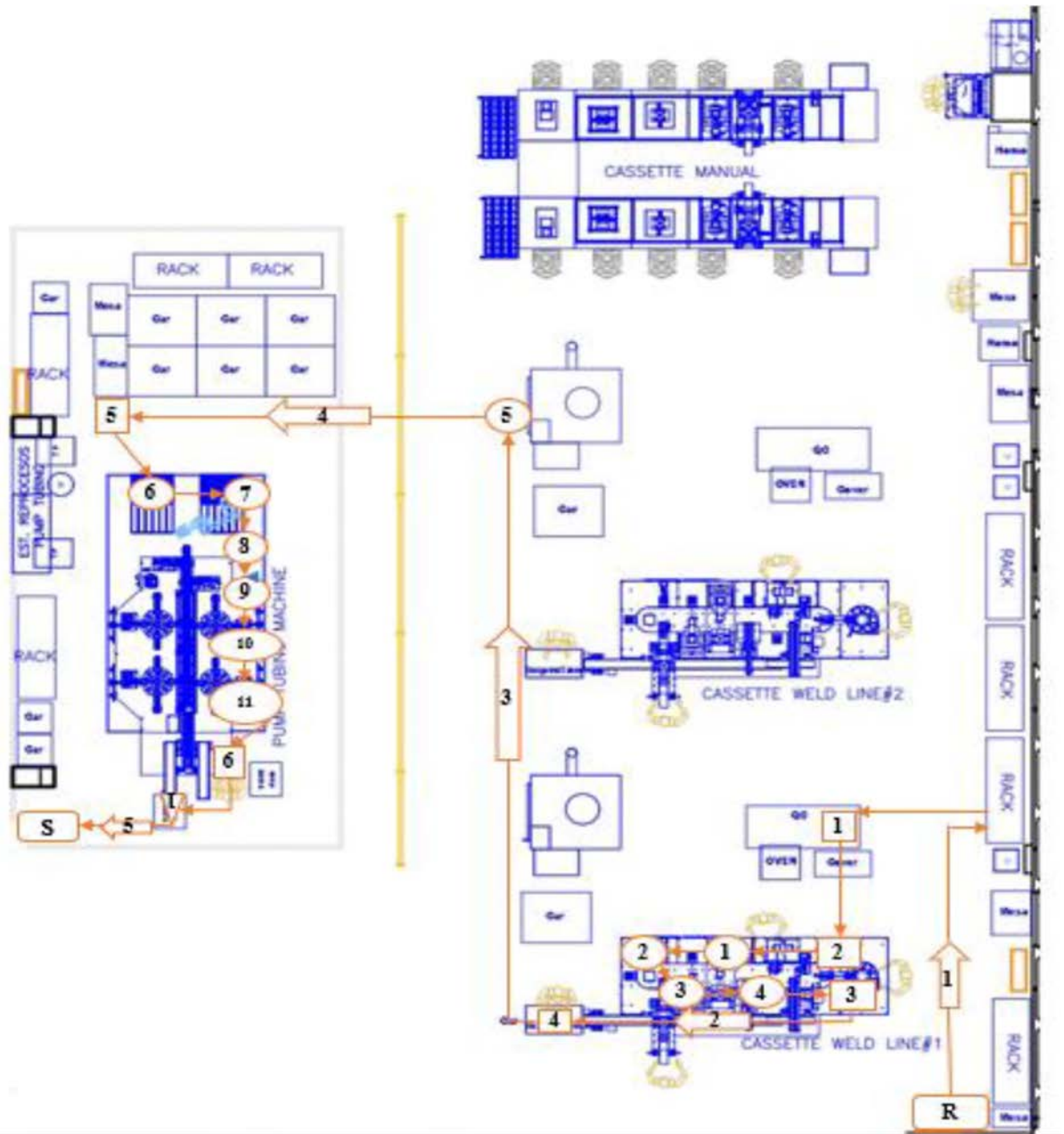
Ilustración 19. Diagrama de Recorrido del Área de Cassette Fuente: Plano realizado en colaboración con la empresa Fresenius Kabi Haina
