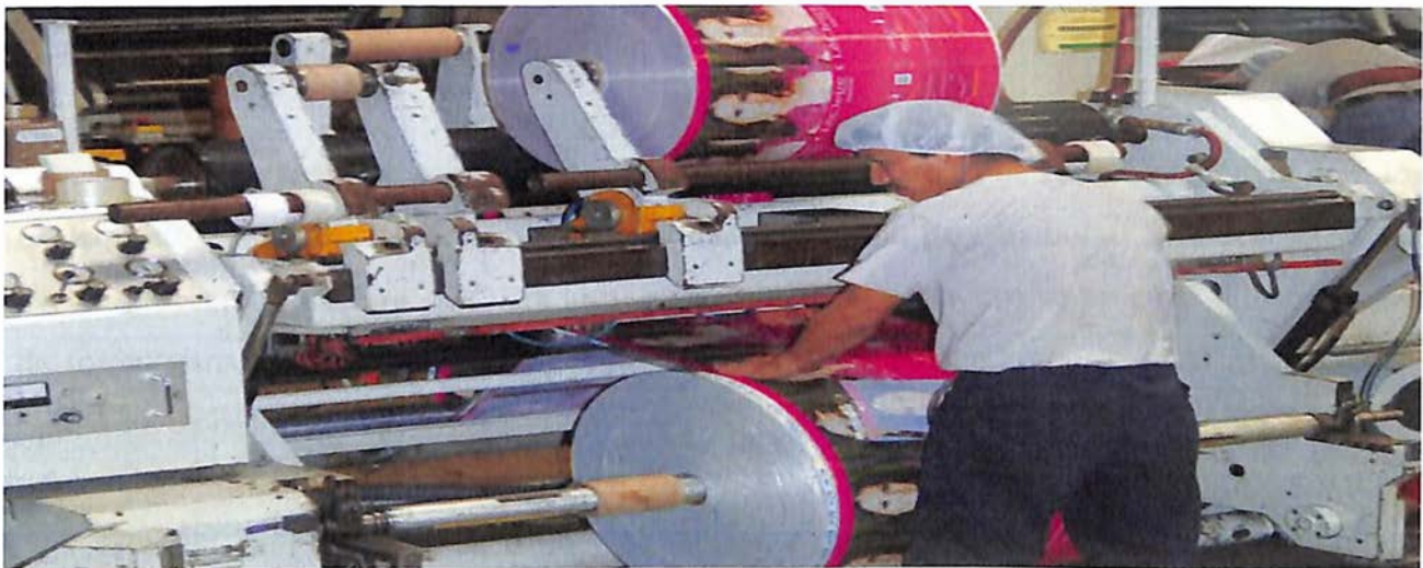
Ilustración 4.4. Proceso de Slitter de Plásticos.
