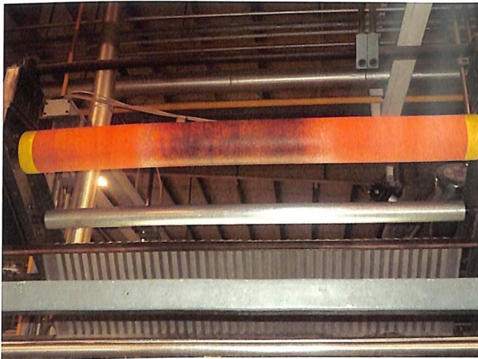
Figura 9: Rolo del balancín de salida contaminado
