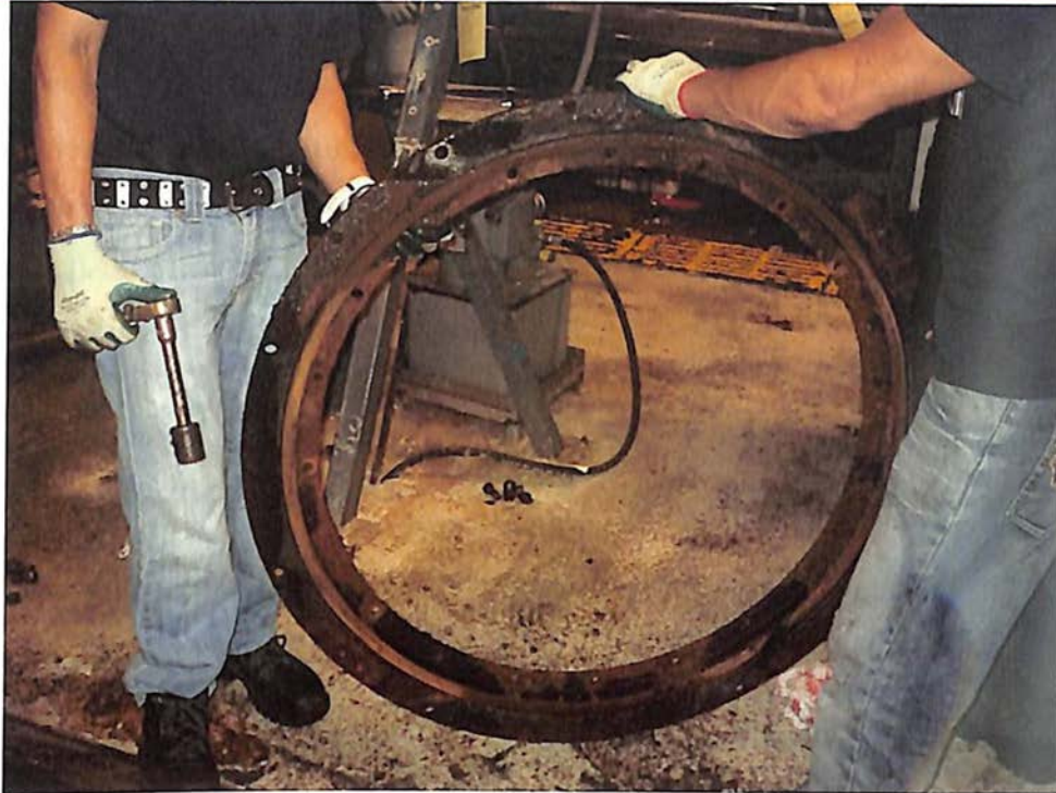
Figura8: Base de plato giratorio en mal estado.
