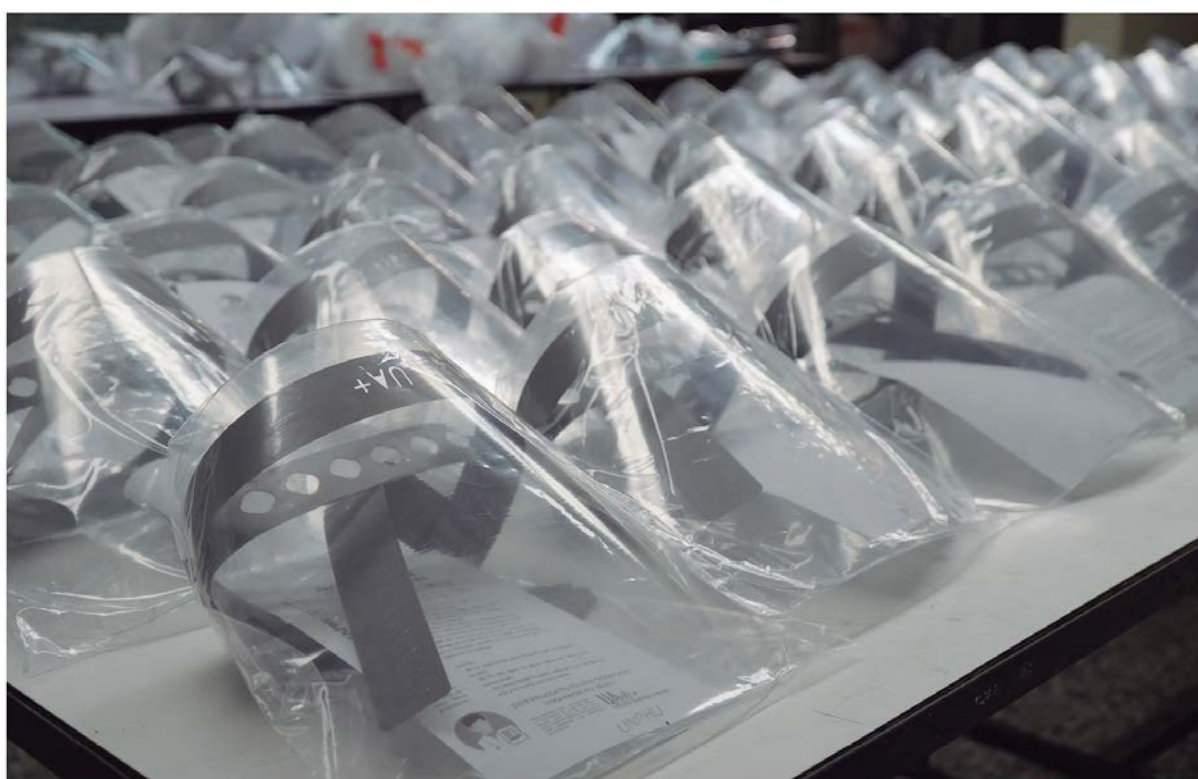
Máscaras de protección moldeadas en las impresoras 3D de la Unidad de Arquitectura Avanzada de la Facultad de Arquitectura y Artes.
