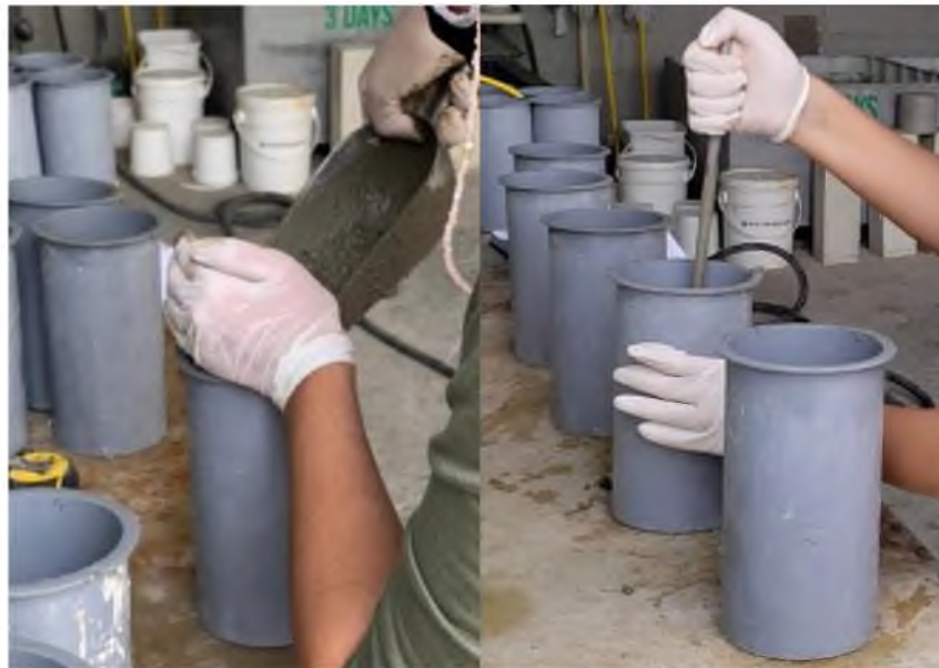
Fig. 10. Proceso de moldeado de especímenes.
