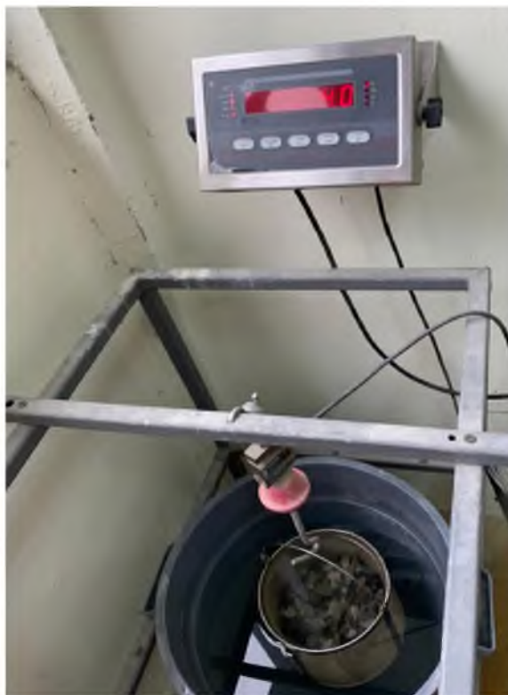
Fig. 5. Sumersión de agregado grueso en condición SSS en agua a temperatura ambiente.
