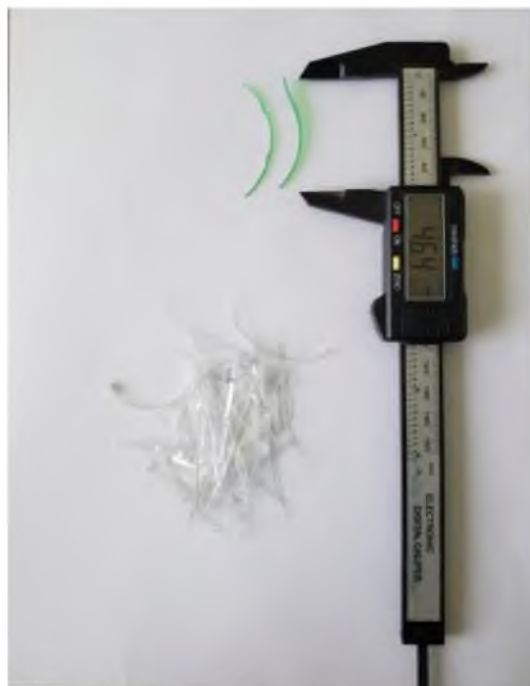
Fig. 4. Medición de longitud aproximada de fibras de PET.
