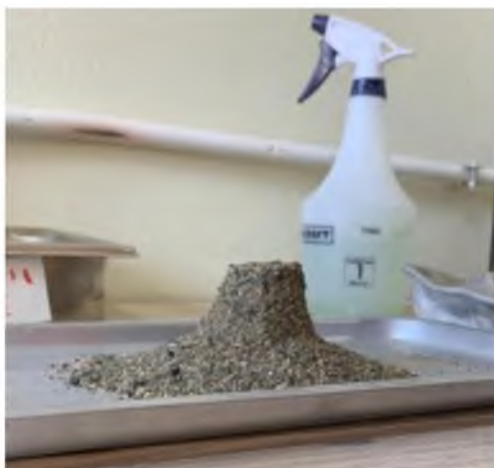
Fig. 6. Agregado fino en condición SSS.
