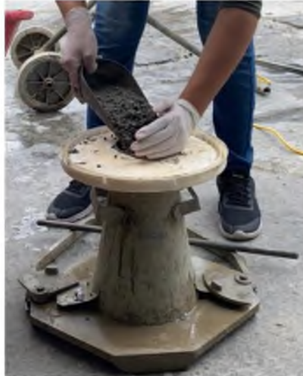
Fig. 9 Prueba de asentamiento del concreto.
