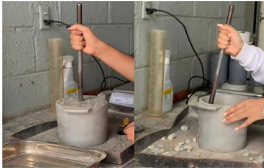
Fig. 7. Proceso de apisonamiento de capas de agregado fino y grueso para determinar peso unitario y porcentaje de vacíos.
