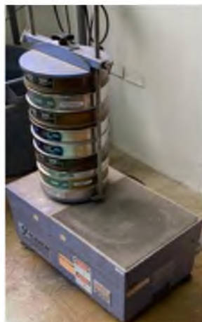
Fig. 8. Serie de tamices colocados en el agitador mecánico.
