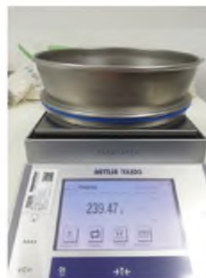
FIGURA 5. PESAJE DE BALINES Y TAMICES VACÍOS
