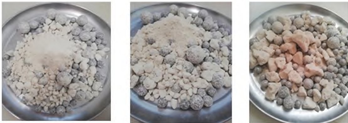
FIGURA 8. RESULTADO POST MOLIENDA DE ARCILLA
