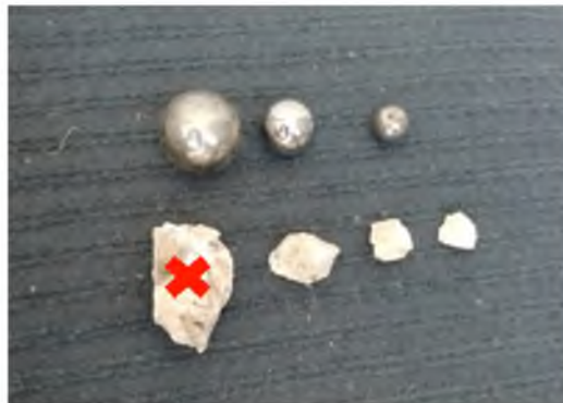
FIGURA 4. COMPARACIÓN PARTÍCULAS TRITURADAS Y SIN TRITURAR, PRUEBA M1
