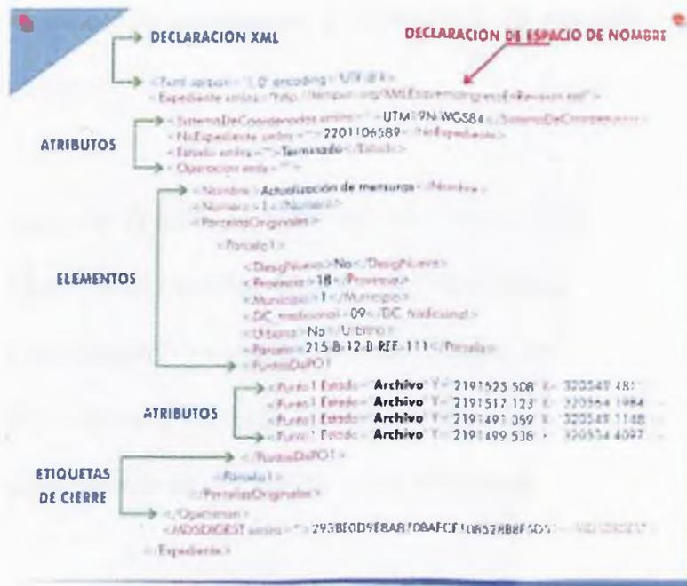
Figura 7- Esquema de Estructura Lenguaje XML. (Ejemplo MIMP)
