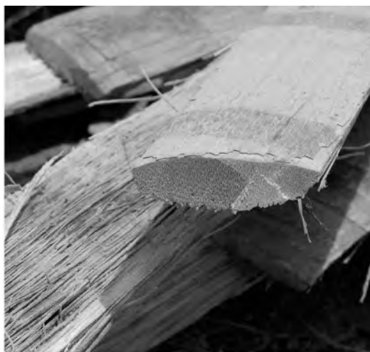
Figura 9 Sección de una tabla de palma (Fuente: Esteban Prieto Vicioso)
