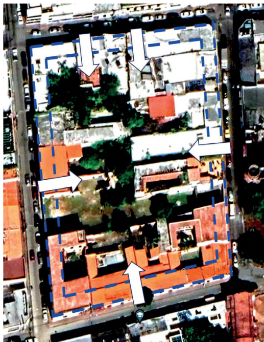
Figura 1 Manzana 407 en la actualidad. Se marcan con línea punteada el área de primera crujía y con flechas los accesos a través de portones originales. (Elaboración propia sobre foto Google)
