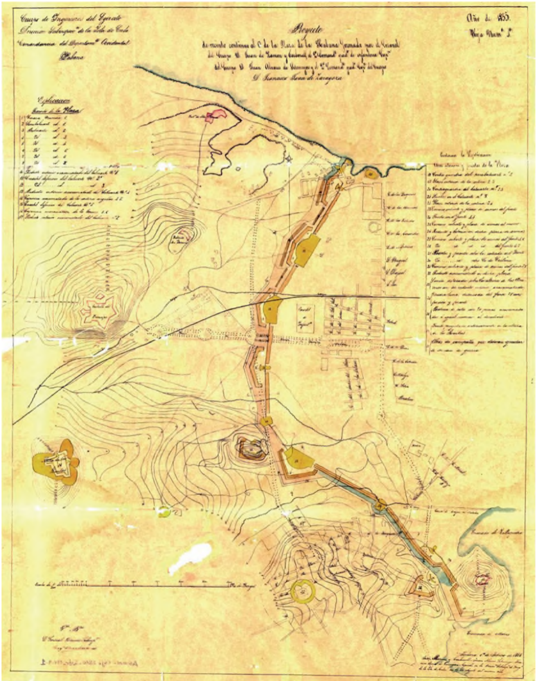
Figura 9 Planta general de la gran muralla fusilera con sus cuarteles y reductos entre San Lázaro y Atarés (AGMM, caja 2810, 171-3-1)
