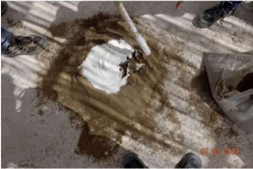
Figura 1 Apagado en volcan de la cal viva (Foto Luis Prieto)
