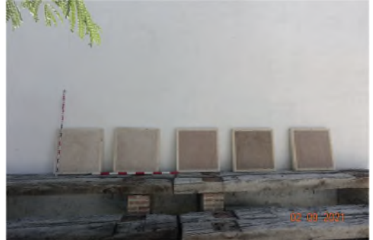
Figura 2 Diferentes tonos según los diferentes agregados. (Foto Luis Prieto)
