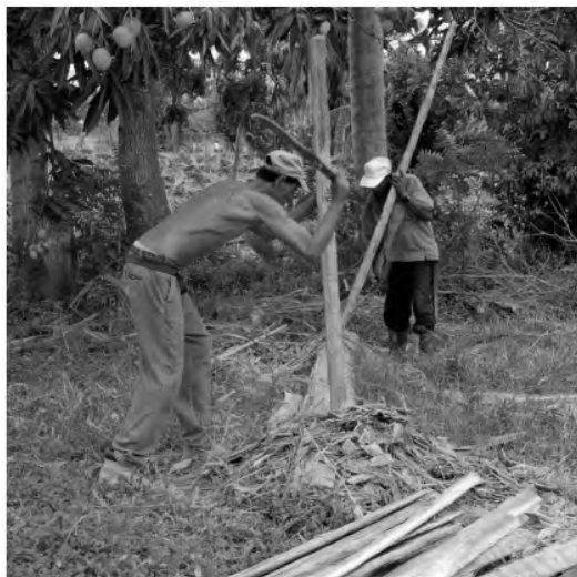
Figura 8 Limpieza de la tabla de palma quitando los filamentos interiores (Fuente: Esteban Prieto Vicioso)
