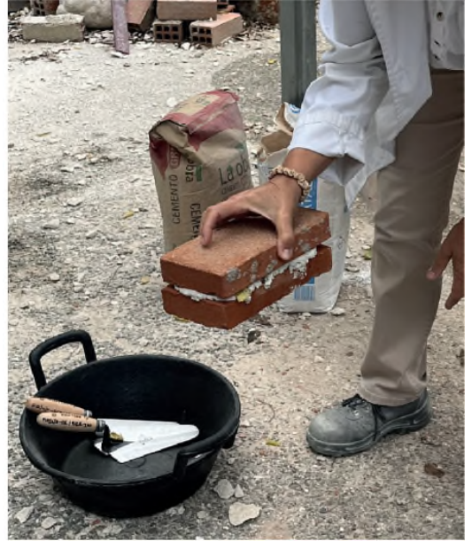
Figura 6 Dos ladrillos recién recibidos con mortero de cal se adhieren hasta el punto de poder sostener el conjunto agarrando solamente el superior
