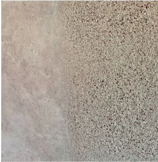
Figura 10 Izquierda opus signinum sin desgaste, derecha desgastado por el uso. (Foto Luis Prieto)
