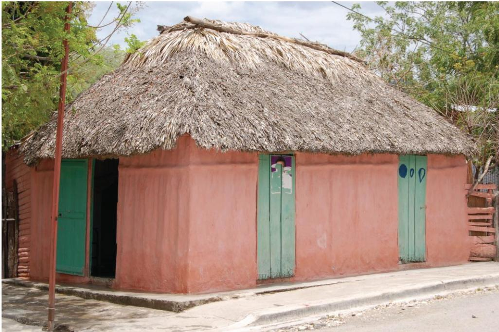
Figura 160. Bohío de palos parados con techo de cana a cuatro aguas, en Las Charcas, Azua. Foto: EPV. 2008
