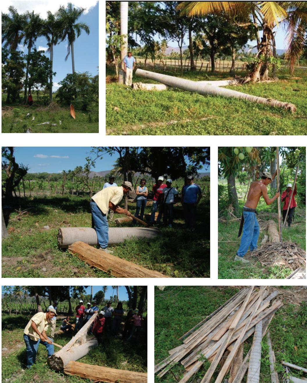
Figura 123. Proceso de extracción de las tablas de palma real (*Roystonea hispaniolana*). Foto: EPV. 2007
