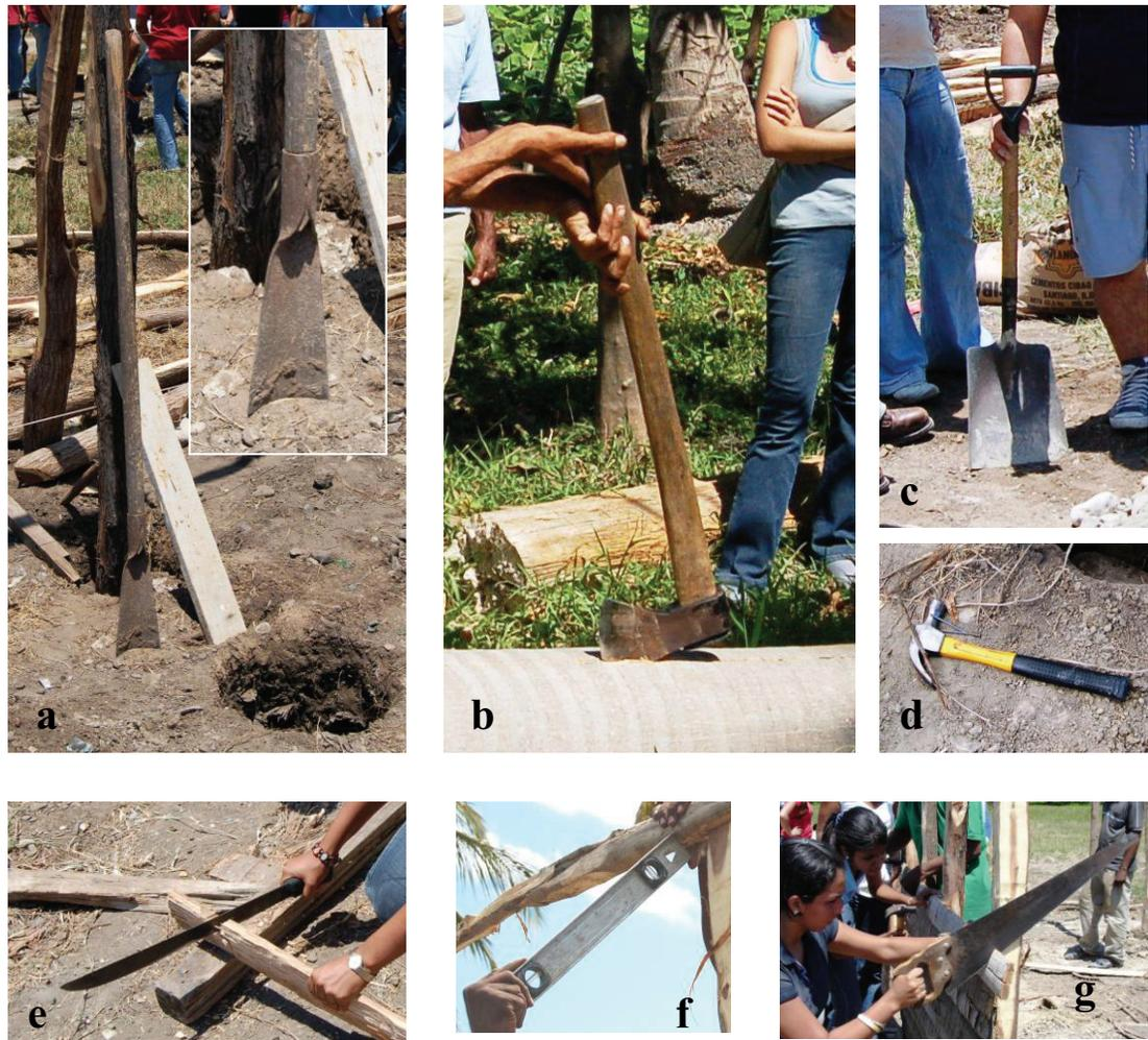
Figura 127. Herramientas que se utilizan actualmente en la construcción de los bohíos. a) Coa; b) Hacha; c) Pala; d) Martillo; e) Machete; f) Nivel; g) Serrucho. Fotos: EPV
