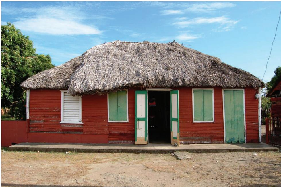
Figura 166. Bohíos de tablas de palma, de dos aposentos, con techos de cana a dos y cuatro aguas, en Pueblo Viejo, Azua y Boca Canasta, Peravia.
