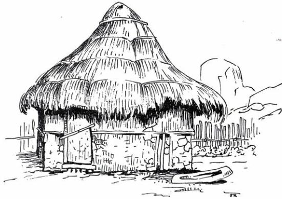
Figura 70. Vivienda Huambo. Estructura de *Pau-a-pique* y paredes embarradas.
