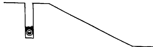
Fig. 7.11 Avenamiento de taludes
