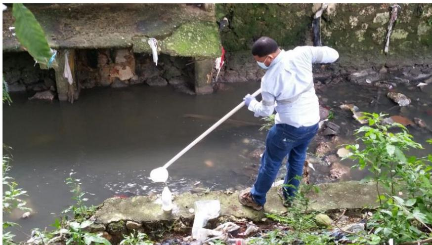
Ilustración 4. Muestra de agua para ensayo en laboratorio
