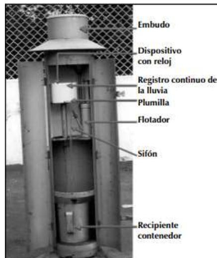
Figura 3. Ejemplo de un Pluviógrafo
