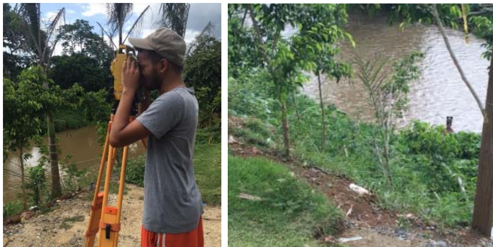
Figura 13. Medición de las secciones utilizando Estación Total. Fuente: Propia.
