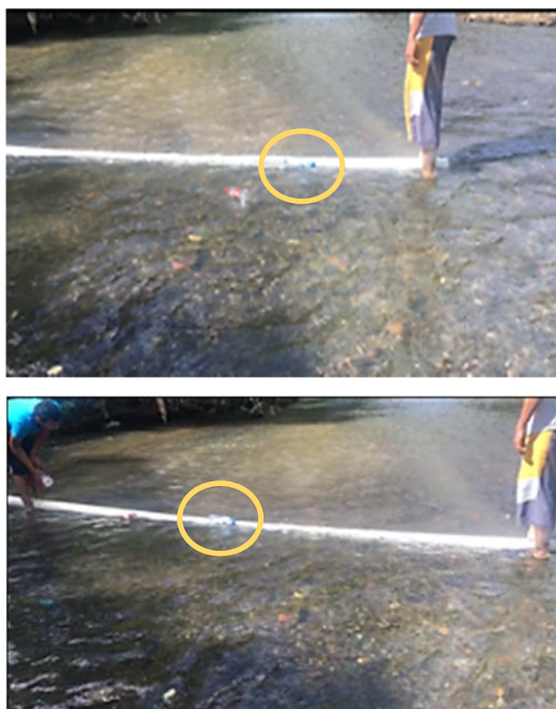
Figura 11. Tubo PVC de 3" simulando ser el dispositivo, apoyado y nivelado por personas. Fuente: Propia.
