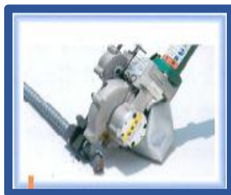
Fig. 6.9 Corte de las barras.
