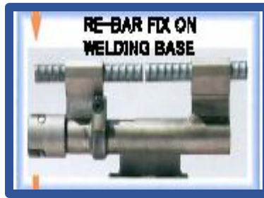
Fig. 6.10 Fijación de las barras.
