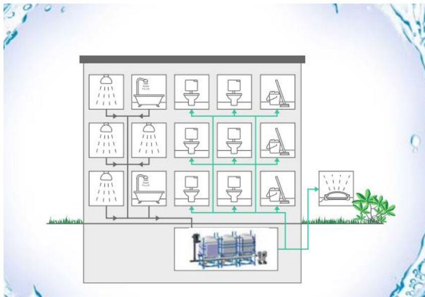
Ilustración 22: Reciclaje de aguas grises Fuente: (Hansgrohe, 2015)
